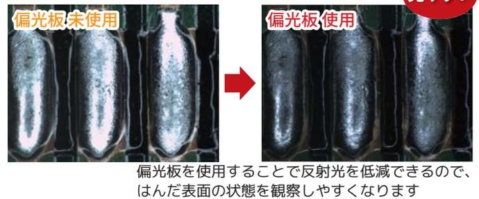
偏光板を使用することで反射光を低減できるので、はんだ表面の状態を観察しやすくなります
