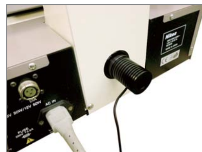
透過照明部へのLED-LH-M40G取付イメージ
