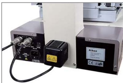
ニコン測定顕微鏡 MM-40 透過照明部
